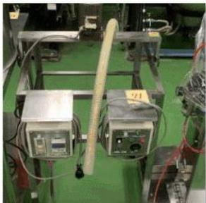
071 混合・沈殿防止攪拌装置付きCタンク
