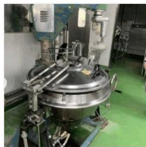
067 攪拌機つきガス回転釜
